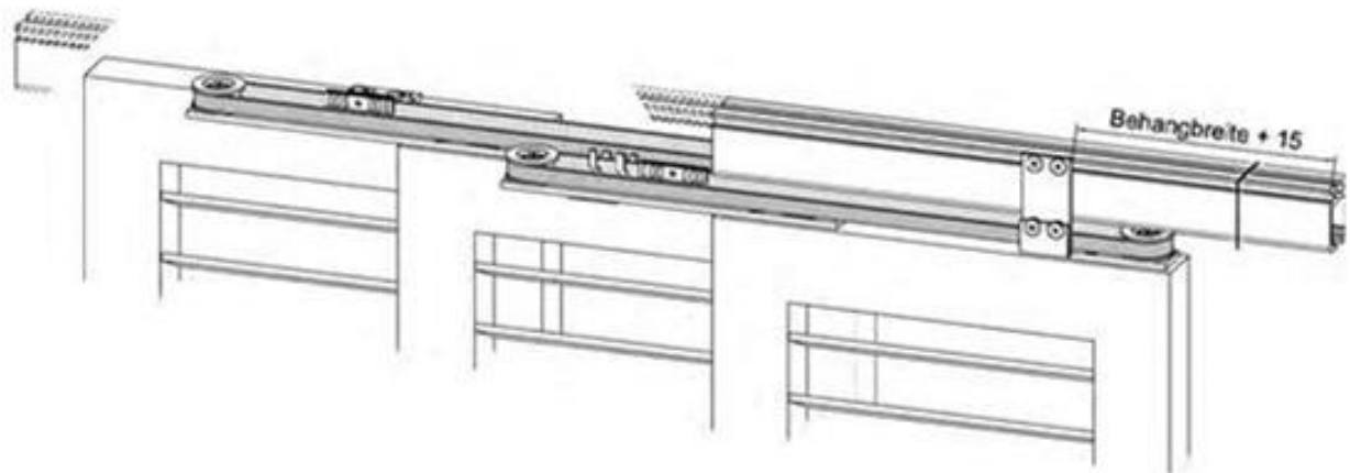
Darstellung geschlossen, mit Zahnriemen und hinterster Laufschiene, von "innen"
